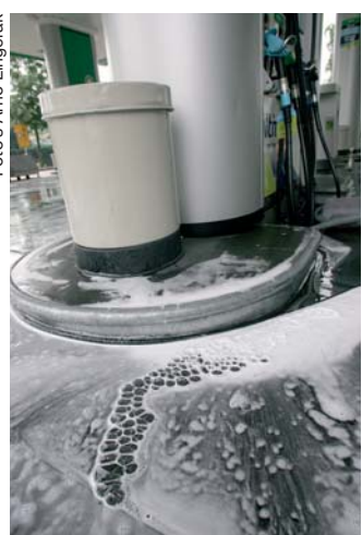
De belletjes geven aan waar de vloer zijn vloeistofdichte karakter heeft verloren.
